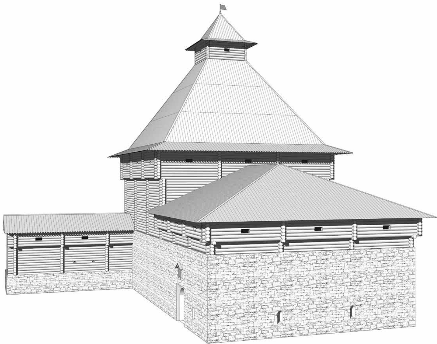
Пятницкая каменно-деревянная проезжая башня (реконструкция на 1630-е годы). Размеры в плане – 43,2×23,76 м, высота каменного основания – 8,6 м; общая высота – 40,5 м. Реконструкция И. П. Кукушкина, Н. И. Калининой. 3D-модель Н. И. Калининой
